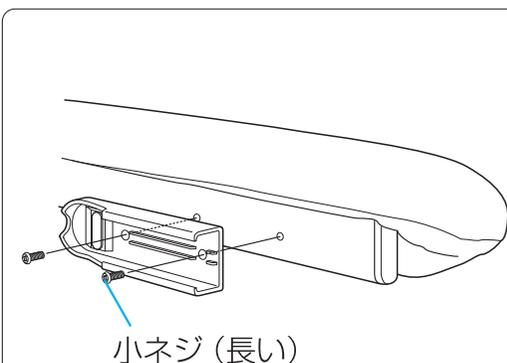
ステアを使用せずに、スイッチホルダーを直接肘掛けに取り付けてもご使用になれます。
